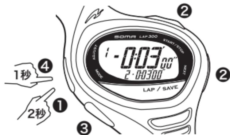
① ダブルリピートタイマーがリセットされている状態で、ADJUST ボタンを 2 秒間押し続けると、タイマー 1 の秒表示が点滅します。
