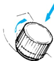
Drehen Sie die Krone unter leichtem Druck.
