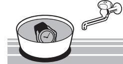
使用清水清潔腕錶，沖洗掉海水並徹底擦乾防止生鏽。
