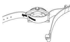
3. 將錶帶頭穿過 6 點鐘方向的固定圈 ①。此時錶帶已安裝到錶殼，可以將手錶戴到手腕上。
