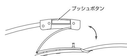
② ピンをアジャスト穴から外します。バンドを左右にスライドさせ、適切な長さのところで、ピンをアジャスト穴に入れます。上箱を押し、中留を留めます。
